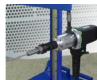
EB-1 электропривод под управлением TES100
