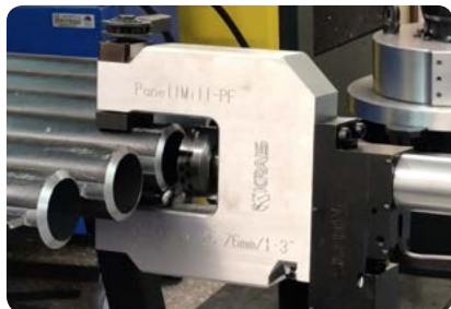
Удаление мембран на глубину 25 мм
