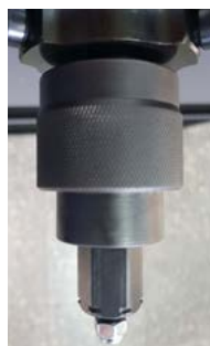
Удобная система блокировки рукоятки подачи для предотвращения случайного перемещения рукоятки во время обработки фланца.
