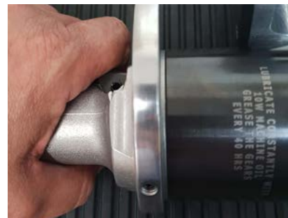
Защита рук от случайного удара вращающейся головки.
